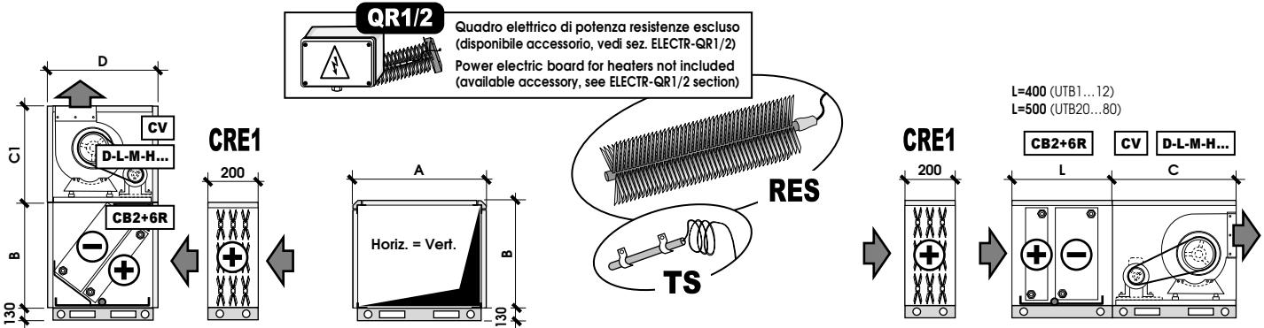
**SEZIONE RISCALDAMENTO CON RESISTENZE ELETTRICHE**
