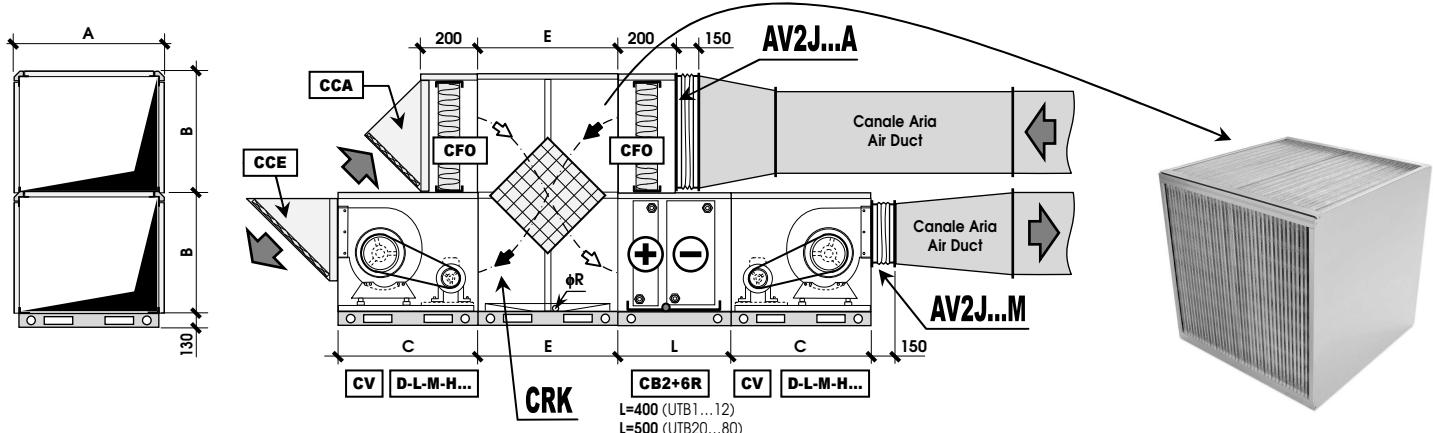
La sezione "CRK" prevede un recuperatore installato all'interno di un Box realizzato secondo le specifiche previste (basamento + telaio + pannelli).
